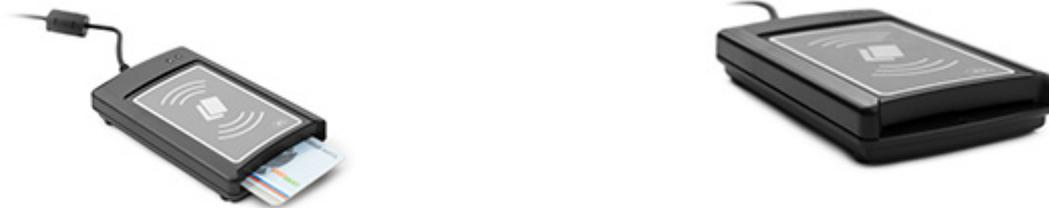
Считыватель поддерживает стандарт PC/SC и отличается высокой скоростью чтения/записи (848 kbps для бесконтактных карт). Он также поддерживает гибридные и комбинированные смарт-карты. К тому же, ACR1281U-C1 имеет встроенный SAM-слот для обеспечения безопасности операций с контактными и бесконтактными картами.
