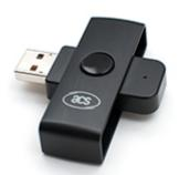
АСR38U-N1 поддерживает смарт-карты класса A, B и C стандарта ISO 7816 (5 B, 3 В и 1,8 В), микропроцессорные карты с протоколами T=0, T=1 и наиболее распространенные карты памяти. Соединение с компьютером осуществляется посредством высокоскоростного USB-интерфейса, скорость чтения / записи на смарт-карту составляет 344 Кбит/с. Это небольшое устройство является очень мощным, так как в него встроено ядро АСR38, поддерживающее самые сложные применения смарт-карт.
