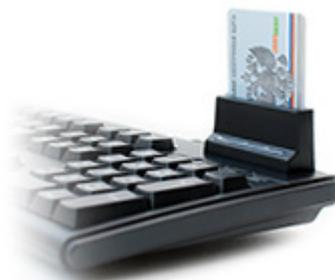
ACR38K поддерживает смарт-карты стандарта ISO 7816 A/B/C. Оно работает с различными картами памяти и с микропроцессорными картами с протоколами T=0 и T=1. В ACR38K реализован высокоскоростной USB-интерфейс, скорость чтения / записи на смарт-карту составляет 344 Кбит/с. Количество циклов подключения карты составляет не менее 100 000.
